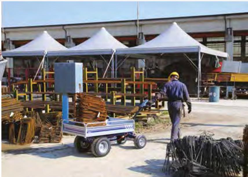
Il carrello elettrico a 4 ruote **JESPI** è robusto, semplice da usare e può trasportare sul suo pianale carichi **fino a 1.000 kg** su piano. Adatto sia per l'uso all'esterno che all'interno, è lo strumento ideale per trasportare materiale pesante e ingombrante come sacchi di cemento, materiale edile ingombrante e carichi su pallet. Disponibili pianali di diverse misure.
