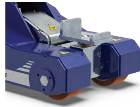
Drehkupplung mit kundenspezifischer Befestigung
